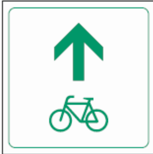
Abbildung 42: Zwischenwegweiser nach FGSV
